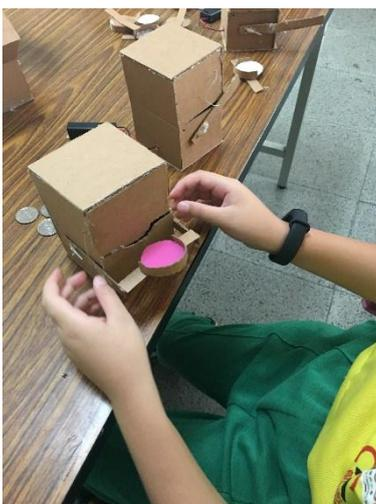
**步驟三：**更換錢盤材質測試各種不同材質的錢盤下，在100次數內，機器人能順利投進盒子的次數。
