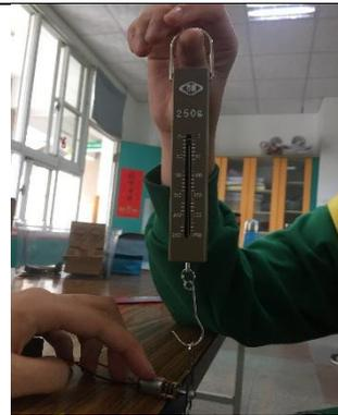
步驟二：彈簧秤測量各種長度軸心吸管，每一次所產生最大的扭力，共10次。
