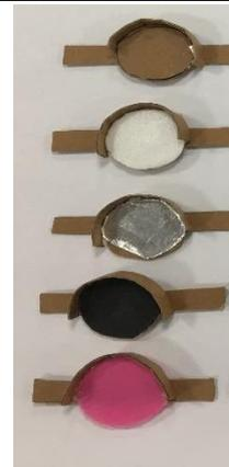
**步驟二：**製作不同材質的錢盤由下而上(PP板、砂紙、鋁箔紙、珍珠板、塑膠片)
